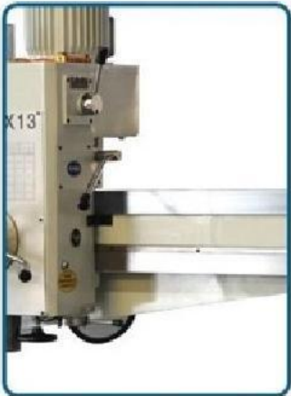
导轨淬火处理 RAIL QUENCHING
